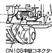
上図のように、端子台手前のガイドにドライバーを差込むと、ガイドが動き、内外接続電線固定解除ボタンを押し、内外接続電線を引くと外すことができます。
