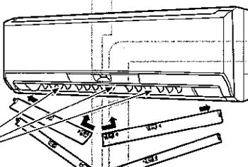
安心ストッパーが正しく挿入されていないと、全てのランプが同時に点滅して、エアコンが運転できなくなります。
