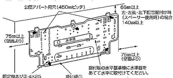
公団アパート用穴使用時は、アンカーボルトの壁面からの飛出し代が15mm以下になるようカットしてください。
