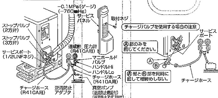
3分程度このままの状態にして針が戻らないことを確認し、ストップバルブ(2方弁、3方弁)の弁棒を反時計方向に当たるまでいっぱいにまわし、全開にする。ストップバーに当たったら、それ以上に力を加えない。
