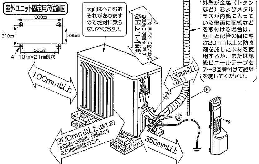
※上記の(←)印寸法は、エアコンの性能を保証するために必要な空間です。後々のサービス、補修なども考慮してできるだけ周囲の空間が大きくとれる場所に設置してください。
