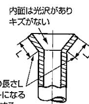
R22用のツールを使ってR410A用のフレア加工をする場合は、A寸法をR22用のときより0.5mm大きくすれば規定のフレア寸法に加工できます。出し代調整用の銅管ゲージを使用すれば、A寸法が確保できます。
