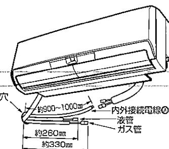
・冷媒配管(延長配管)の引込み長さの目安は、
