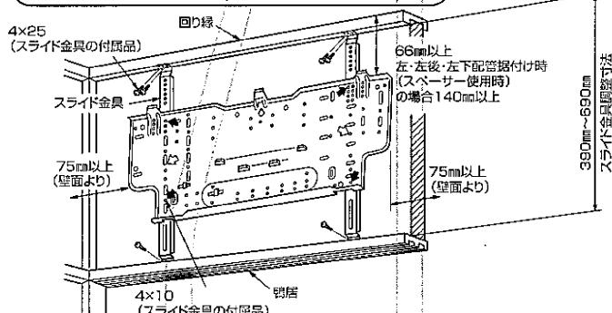
●3尺柱間など柱が壁面より出っ張っている部分は、スライド金具(別売部品)または木材など(現地手配)を使用して、室内ユニットが柱に当たらないようにして据付けてください。
