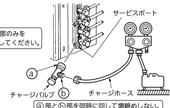
チャージバルブをサービスポートに取付ける際に締め過ぎるとバルブコア（虫ピン）の変形・緩みによるガス漏れのおそれがあります。
