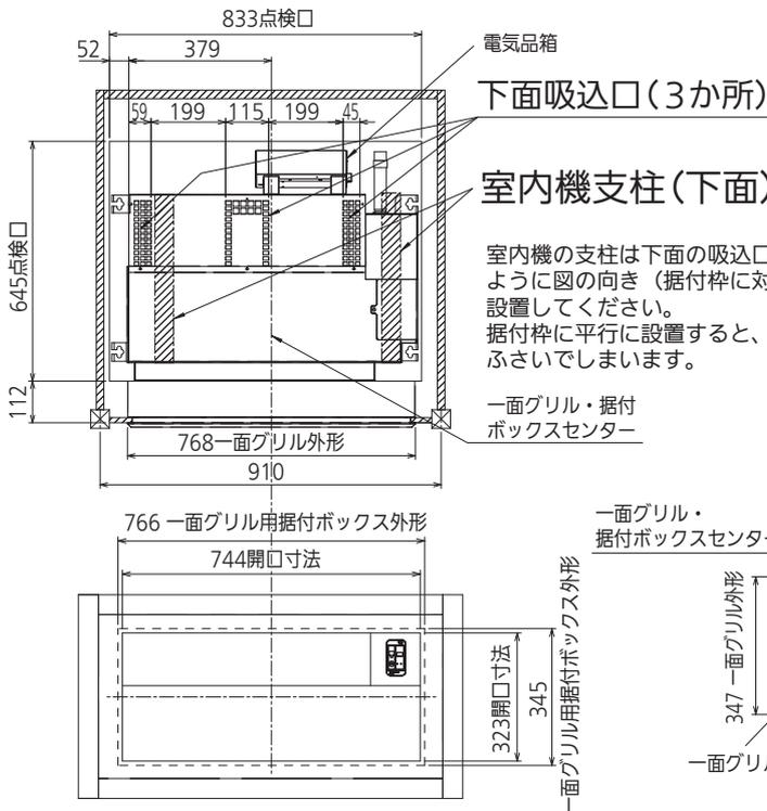
半間幅地袋設置の場合のみ室内機の天板と底板を下図のように入れ替えてください。
