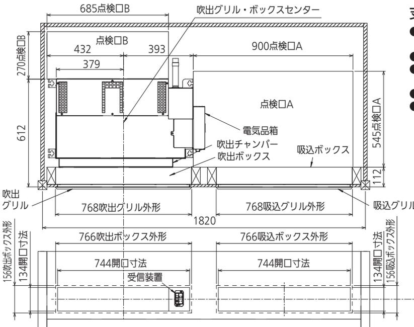
室内機収納室は外部の空気を吸込むことのないように配管貫通部、板の合わせ目などしっかりふさいでください。
