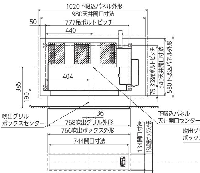
室内機収納室は外部の空気を吸込むことのないように配管貫通部、板の合わせ目などしっかりふさいでください。
