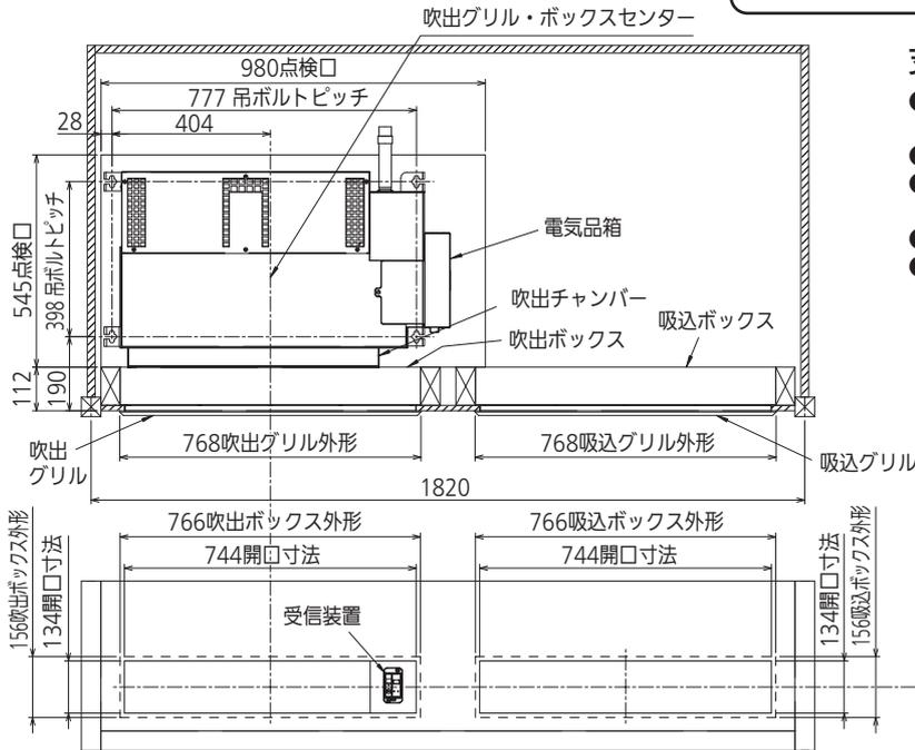
室内機収納室は外部の空気を吸込むことのないように配管貫通部、板の合わせ目などしっかりふさいでください。
