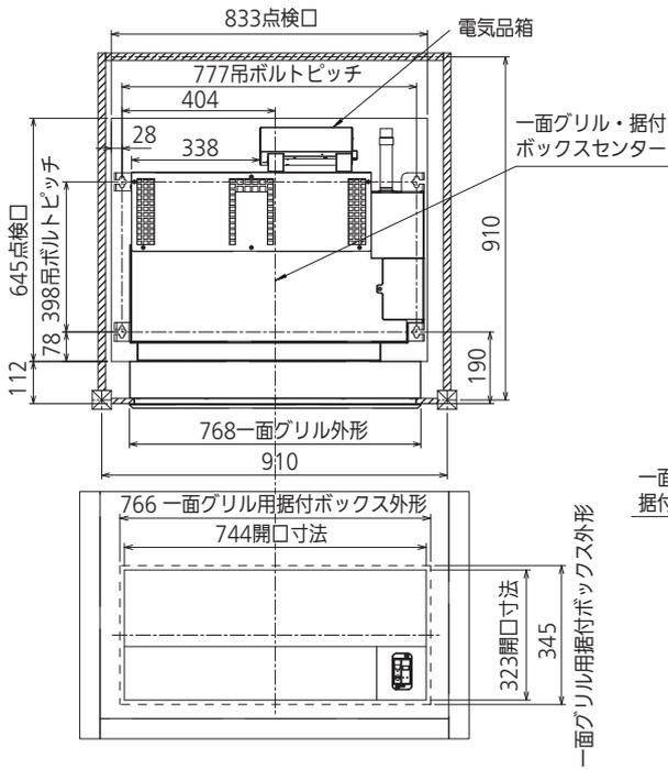
室内機収納室は外部の空気を吸込むことのないように配管貫通部、板の合わせ目などしっかりふさいでください。
