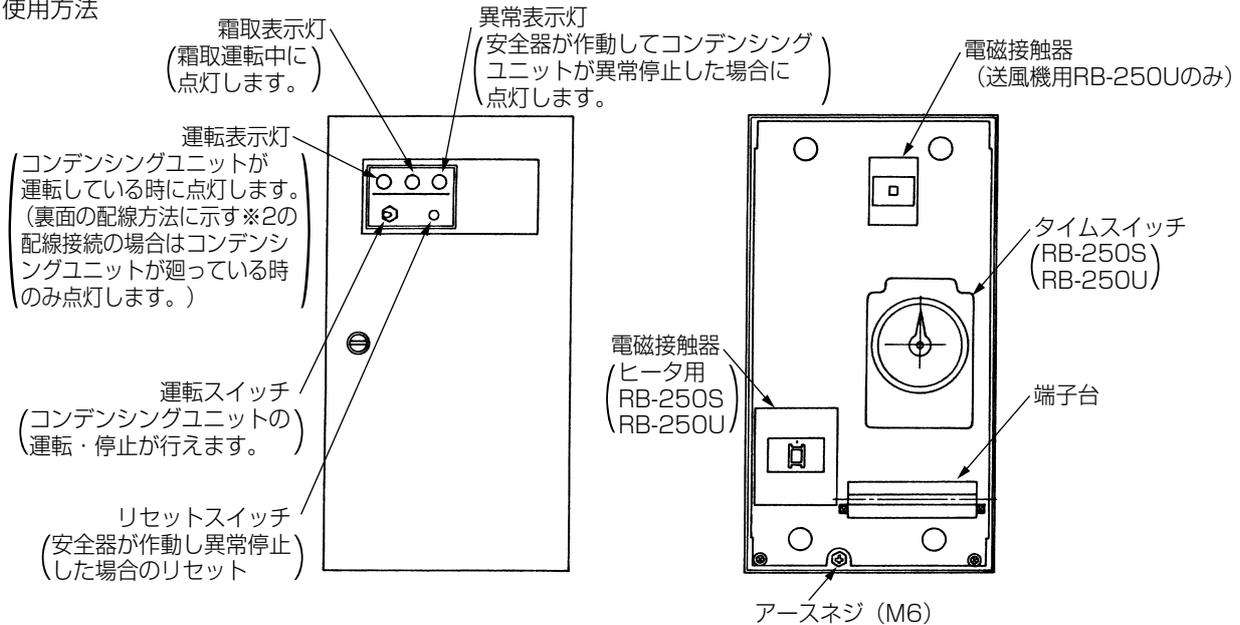
**運転開始** 運転開始時は、運転スイッチを「入」にしてください。運転ランプ（緑色）が点灯し、コンデンシングユニットが運転します。
