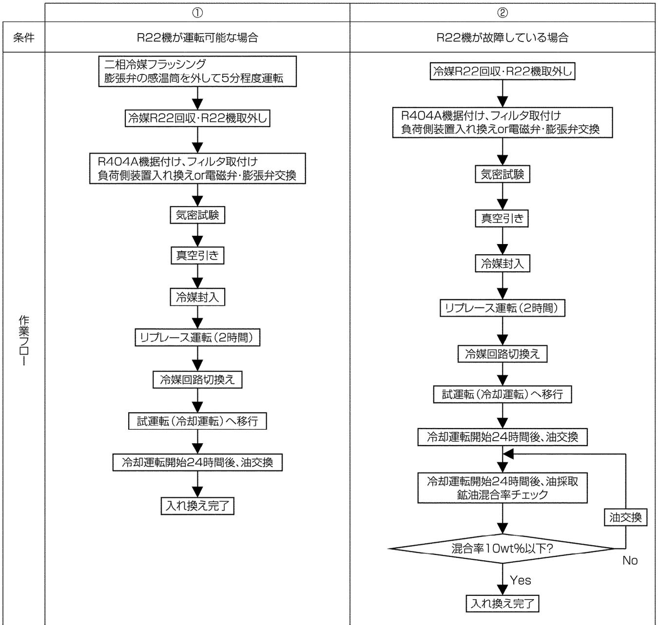
※気密試験、真空引きおよび冷媒封入の方法は、接続するコンデンシングユニットの据付工事説明書に従い実施してください。
