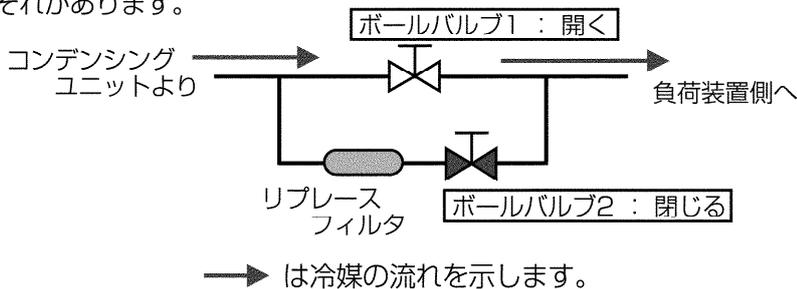
本フィルタユニットを取外すことも可能です。この場合は取外した部分の配管を新規に接続し、真空引きを再度実施してください。なお、フィルタを取外した場合は以下の点に注意してください。
