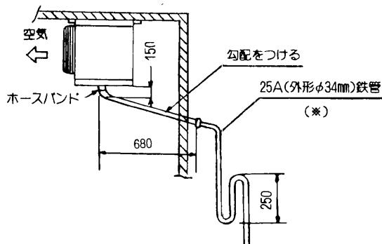
※塩ビパイプを使用する場合は隙間が大きくなり水漏れの原因となりますので吸水性の無いパッキン等を巻きつけ、隙間を小さくしてください。
