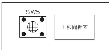
4) 目標蒸発温度設定が完了したら、ロータリスイッチのポジションを「0」「0」とし、通常は低圧圧力 (MPa) を表示させてください。
