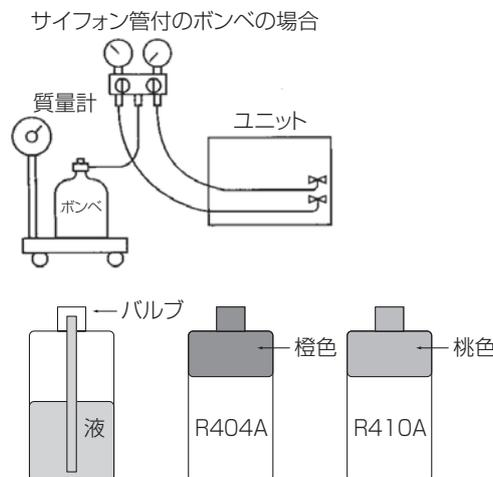
サブクールユニット部は R410A 専用です。R410A をプレチャージ (7kg) していますので、充てんの必要はありません。サービス時は R410A 冷媒をすべて回収してください。サービス後は R410A 冷媒を 7kg 充てんしてください。
