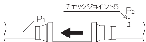
ストレーナ詰まりチェック用チェックジョイント
