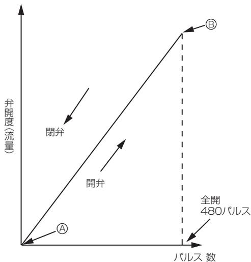
※電源投入時、弁の位置を確定するため520パルスの閉弁信号を出し、必ず(A)点にします。(パルス信号は約17秒間出力されます。)
