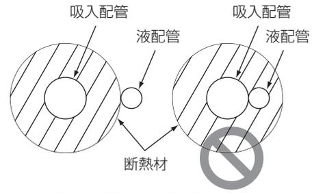
吸入配管と液配管の熱交換禁止
