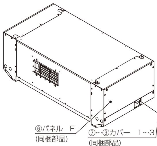
6. 手順 1. ～ 5. までの作業と同様に反対側のパネルを取り付ける。
