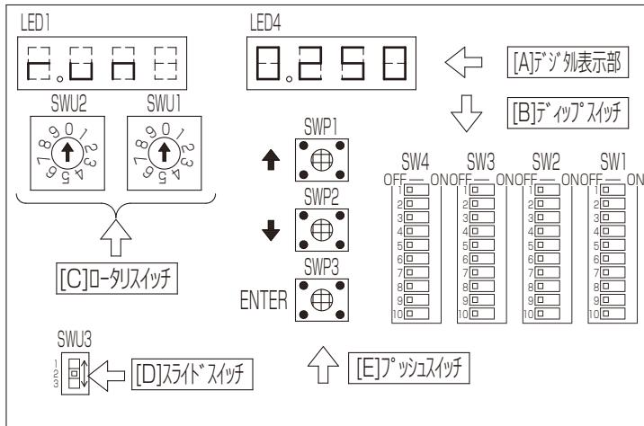
スライドスイッチ SWU3 = 2 (中段) または 3 (下段)、ロータリスイッチ SWU1 = 0、SWU2 = 0 に合わせると次に示す表の運転状態と低圧圧力が交互に表示されます。
