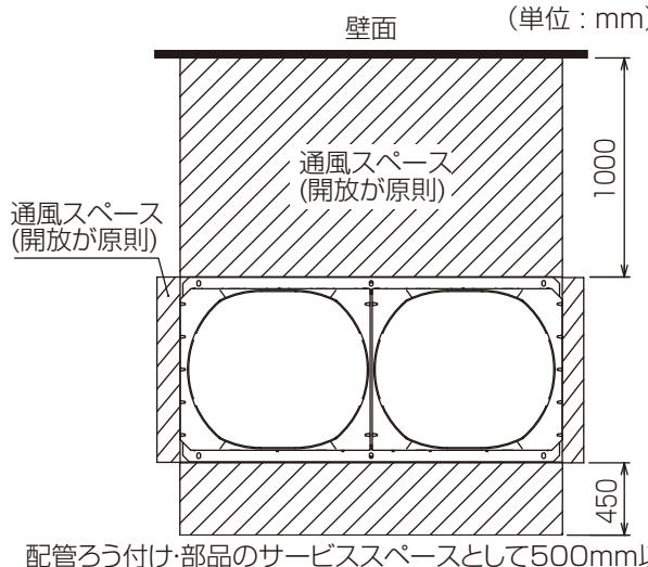
配管ろう付け・部品のサービススペースとして500mm以上を推奨
