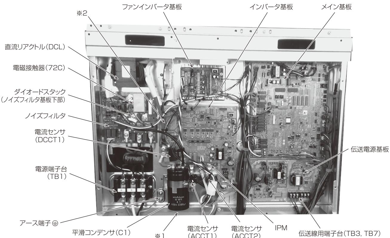
※1 制御箱底面、および制御箱前パネルが変形すると、防水、防じん性能が低下し、部品故障の原因になります。
