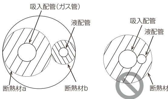
吸入配管と液配管の熱交換禁止
