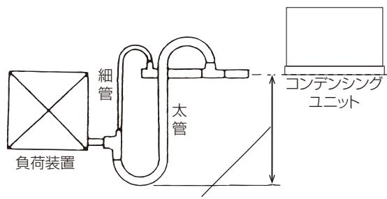
立上り配管が5m以上で流速が6m/s以下の場合は二重立上り配管としてください。
