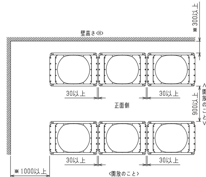
前後、側面の壁高さ<H>が、下記<壁高さ制約>を超える場合<壁高さ制約>を超えた分の寸法<h>を図中にある\*印の寸法に加算してください。
