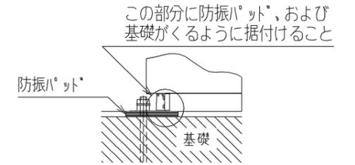
この部分に防振パッド、および基礎がくるように据付けること
