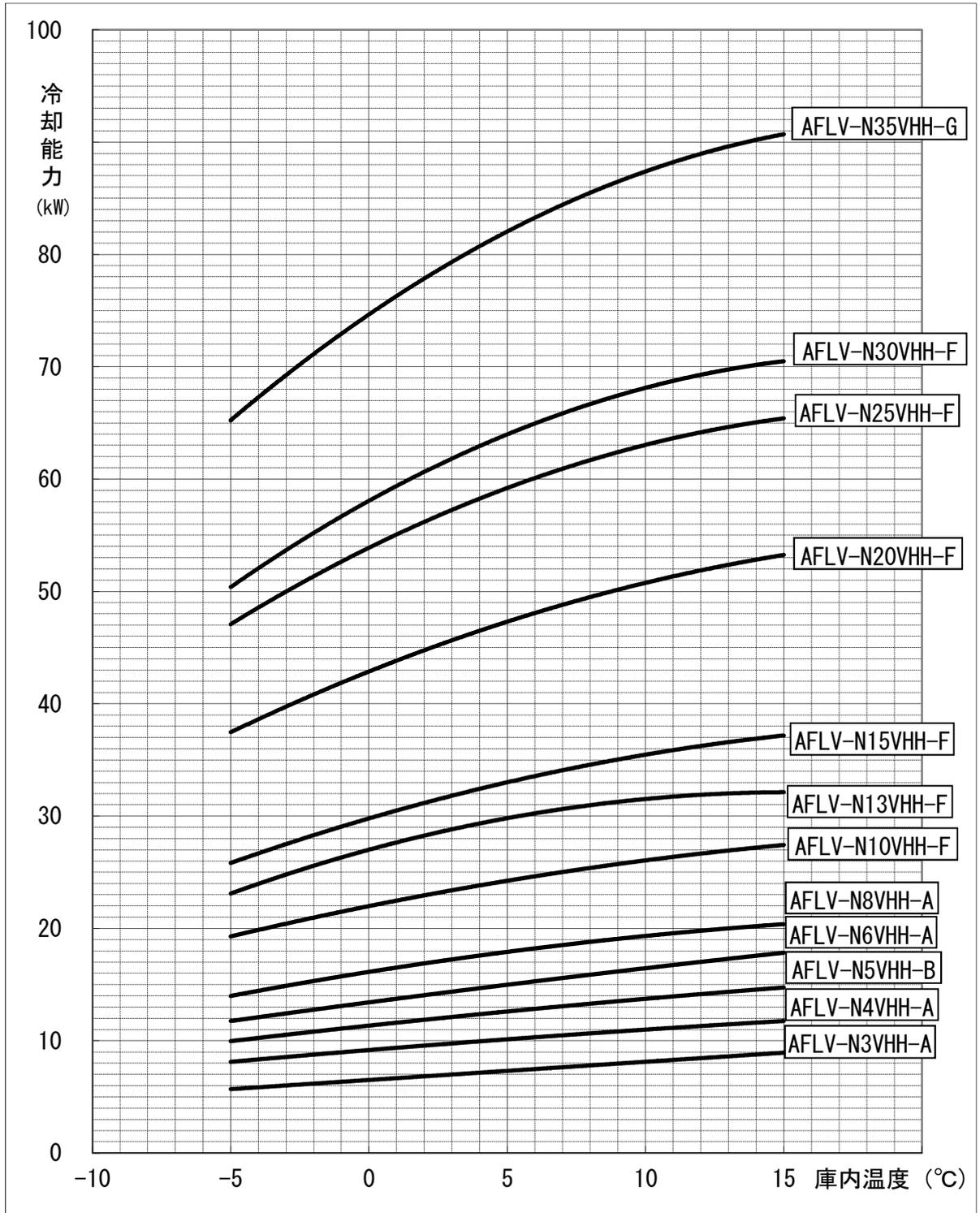
注1. 上記線図は外気32℃、冷媒配管長さ5mにおける値を示します。
