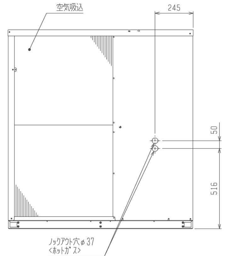
注1. ホットガス配管についてはユニット外取出し後の配管径は下記としてください。(レギュラー現地手配)
