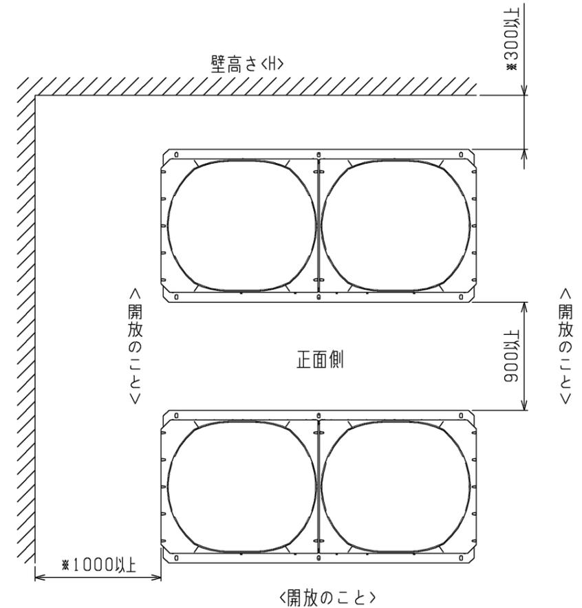
前後、側面の壁高さ<math>H</math>が、下記〈壁高さ制約〉を超える場合〈壁高さ制約〉を超えた分の寸法<math>h</math>を図中にある※印の寸法に加算してください。
