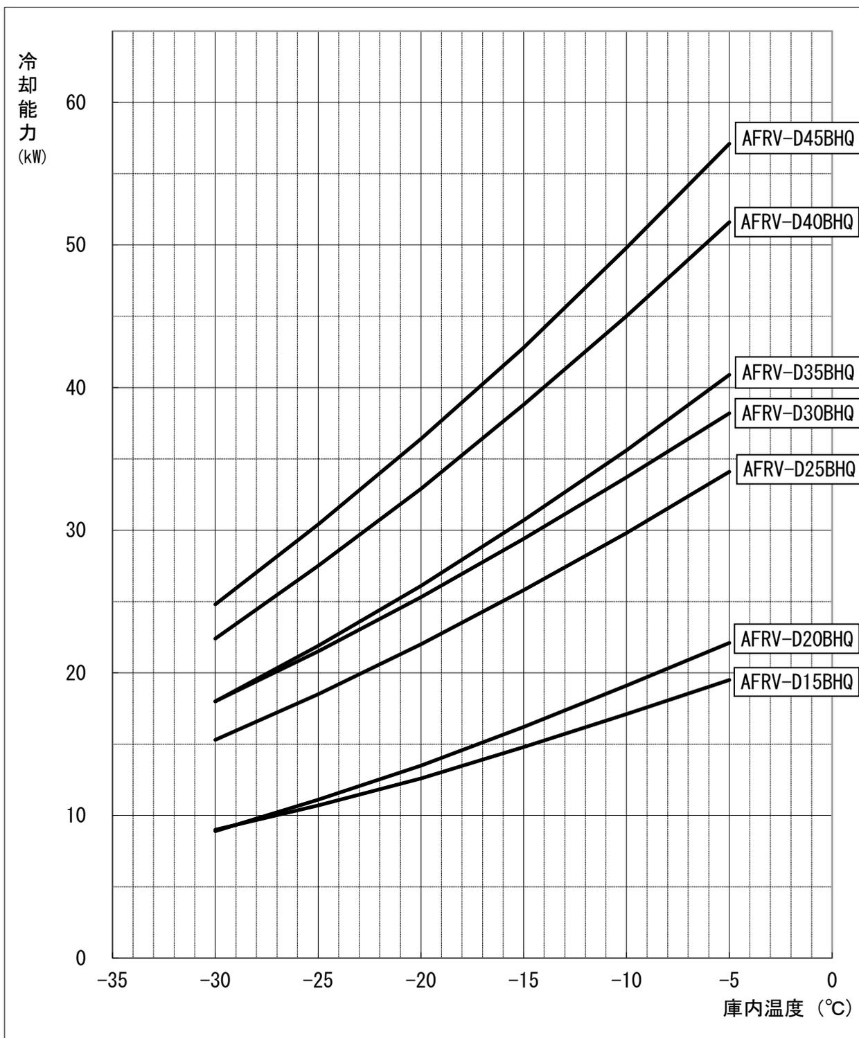
注1. 上記線図は外気32°C、冷媒配管長さ5mにおける値を示します。
