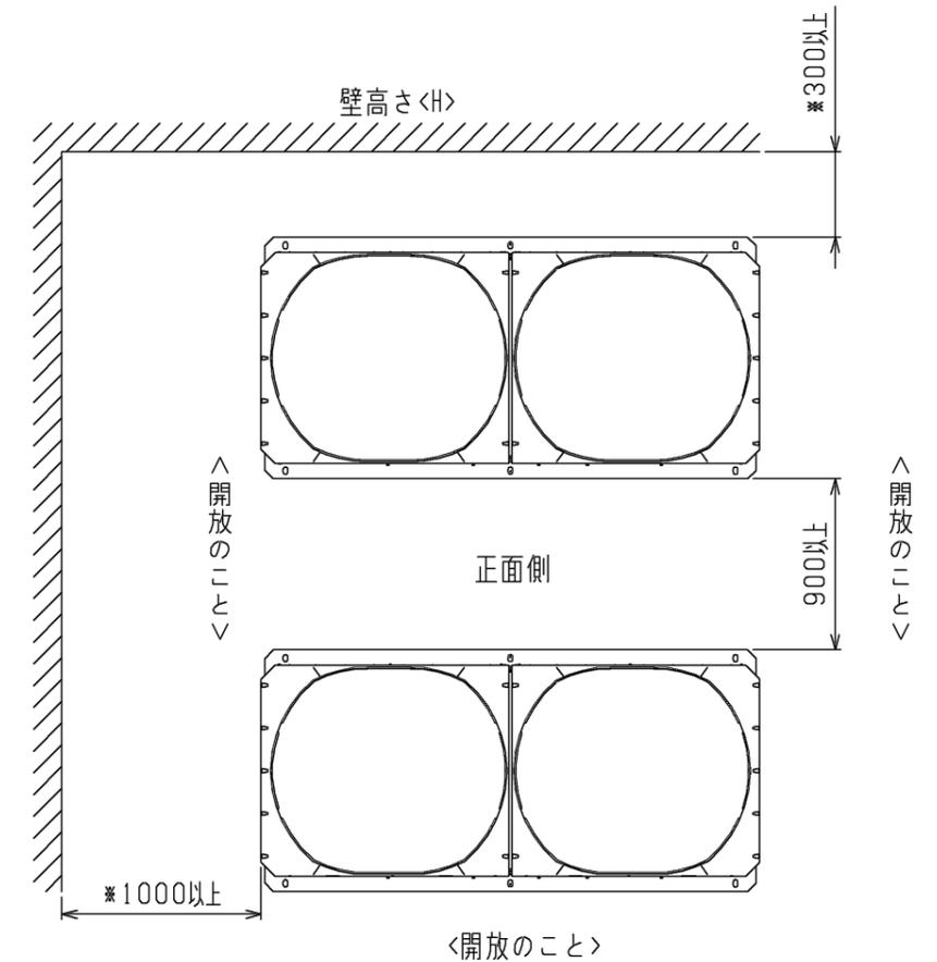
前後、側面の壁高さ<H>が、下記<壁高さ制約>を超える場合<壁高さ制約>を超えた分の寸法<h>を図中にある\*印の寸法に加算してください。
