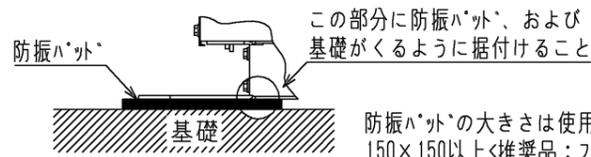
防振パッドの大きさは使用する穴によって異なります。150×150以上<推奨品：フジストン製 IP-1003>
