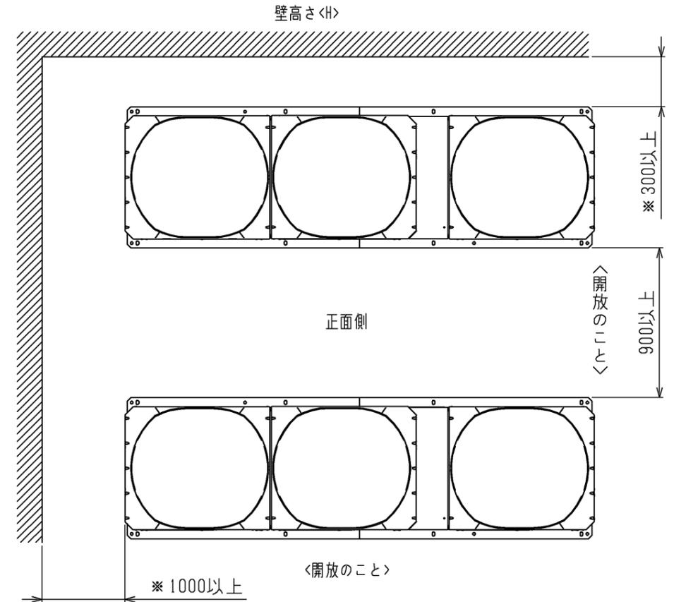
前後、側面の壁高さ<math>\langle H \rangle</math>が、下記<math>\langle \text{壁高さ制約} \rangle</math>を超える場合<math>\langle \text{壁高さ制約} \rangle</math>を超えた分の寸法<math>\langle h \rangle</math>を図中にある、\*印の寸法に加算してください。
