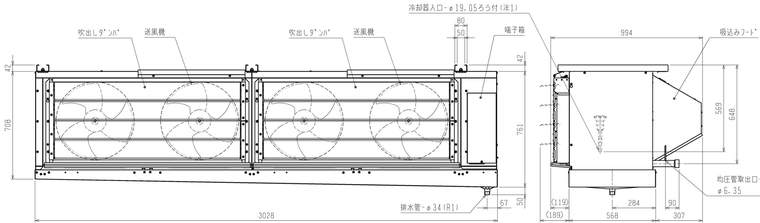
注1. 冷却器入口配管寸法は付属の膨張弁出口径に合わせております。
