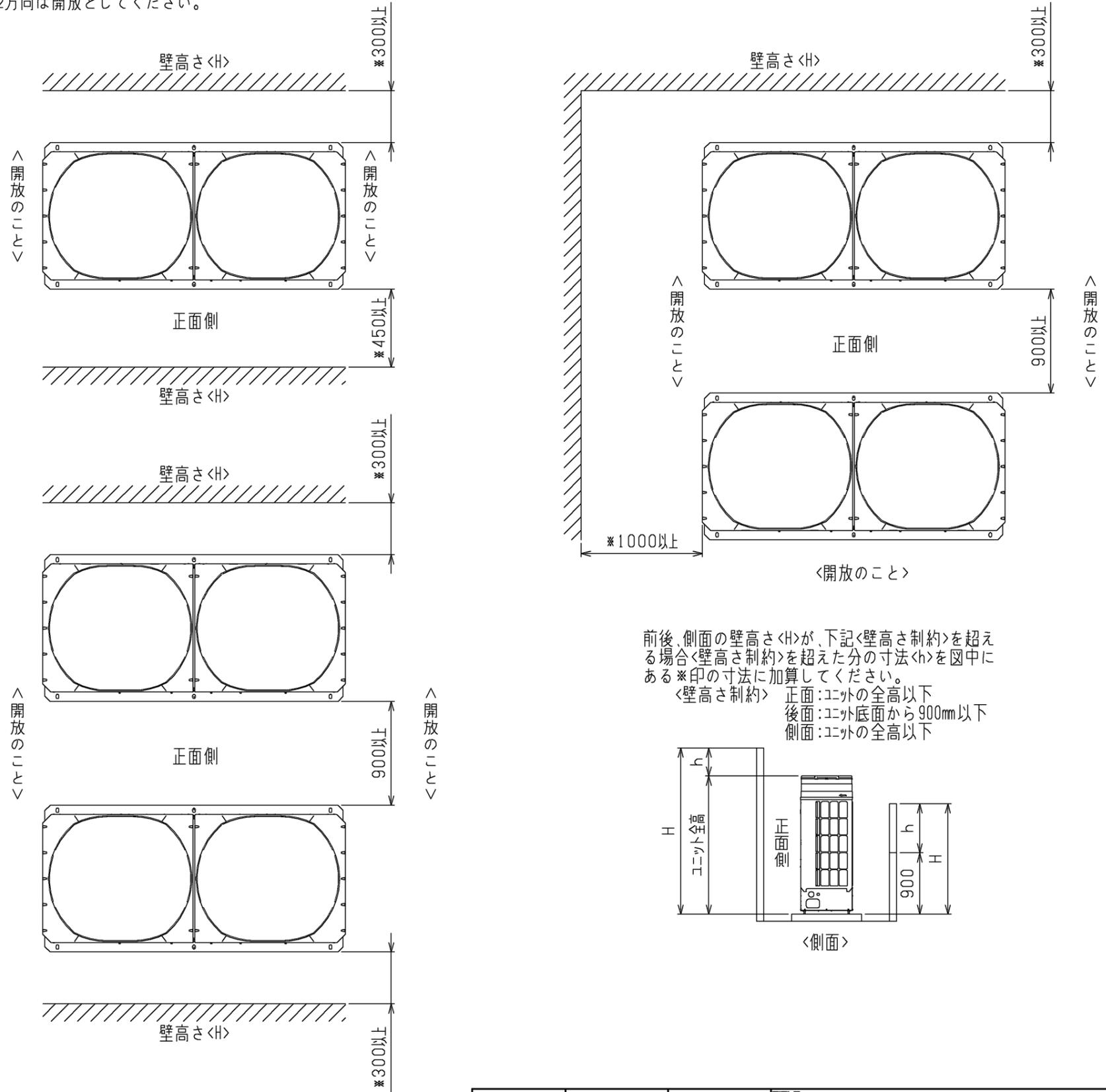
前後、側面の壁高さ<H>が、下記「壁高さ制約」を超える場合「壁高さ制約」を超えた分の寸法<h>を図中にある※印の寸法に加算してください。
