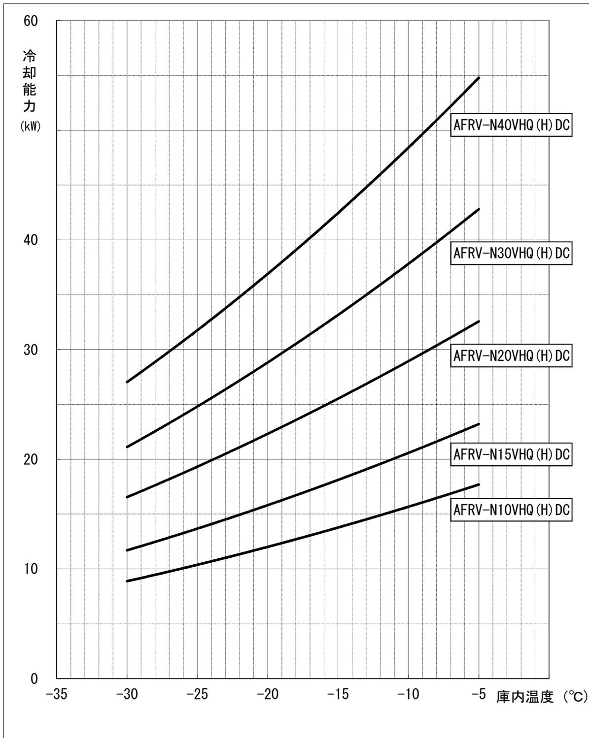
注1. 上記線図は外気32°C、冷媒配管長さ5mにおける値を示します。
