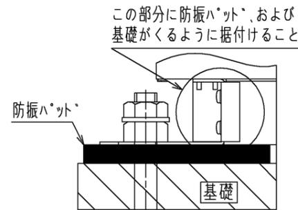
この部分に防振パット、および基礎がくるように据付けること
