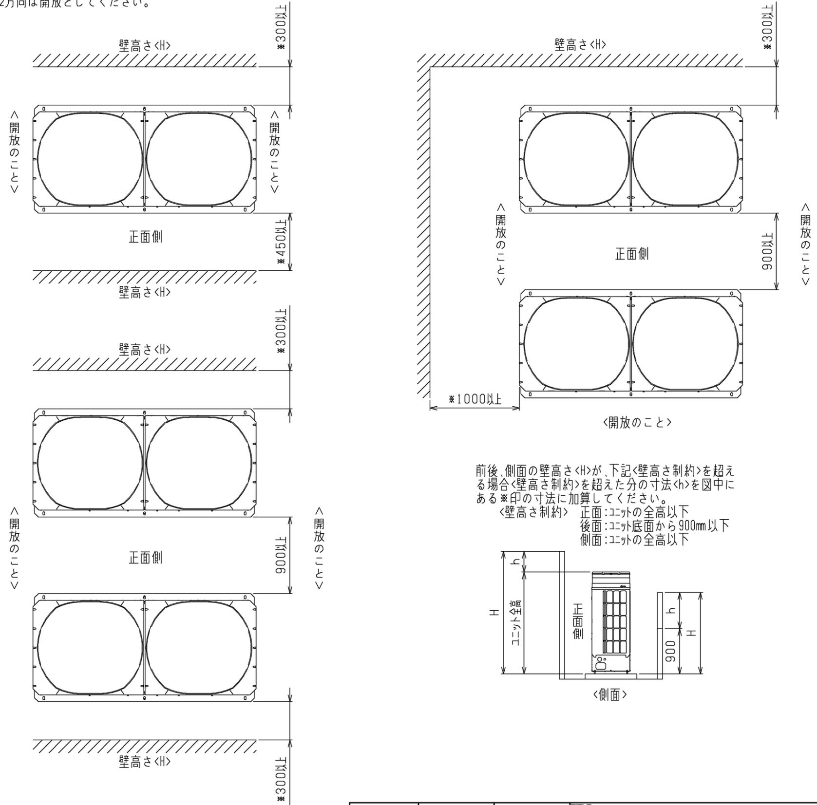
前後、側面の壁高さ<math>H</math>が、下記「壁高さ制約」を超える場合「壁高さ制約」を超えた分の寸法<math>h</math>を図中にある※印の寸法に加算してください。
