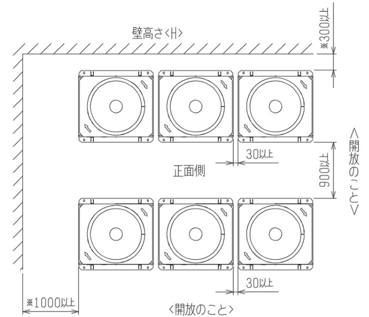
前後、側面の壁高さ<H>が、右記<壁高さ制約>を超える場合<壁高さ制約>を超えた分の寸法<h>を図中にある※印の寸法に加算してください。
