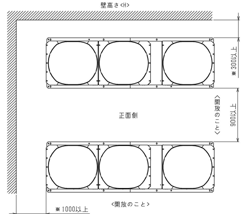
前後、側面の壁高さ<math>H</math>が、下記<壁高さ制約>を超える場合<壁高さ制約>を超えた分の寸法<math>h</math>を図中にある、\*印の寸法に加算してください。
