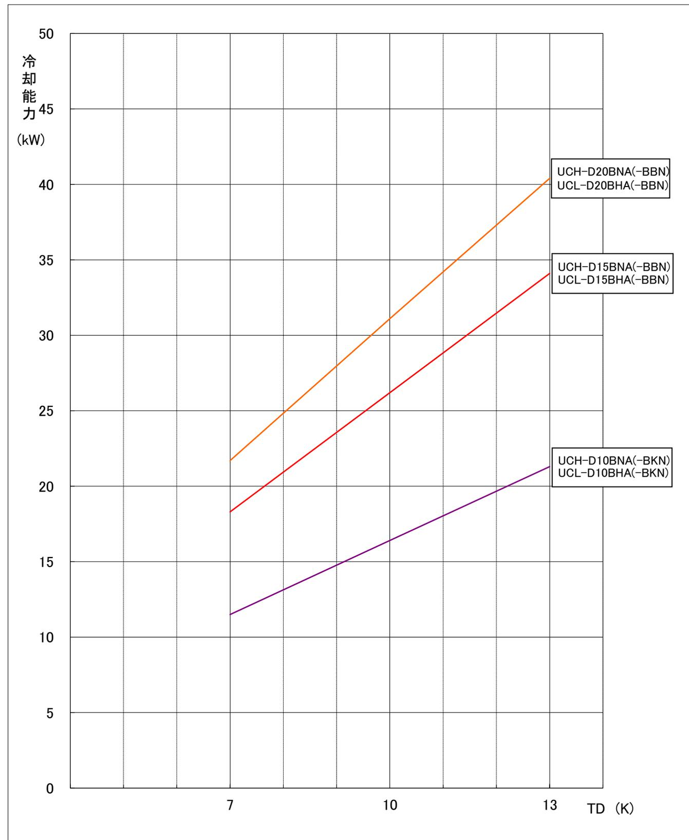
UCH(L)-D形ユニットクーラ冷却能力線図
