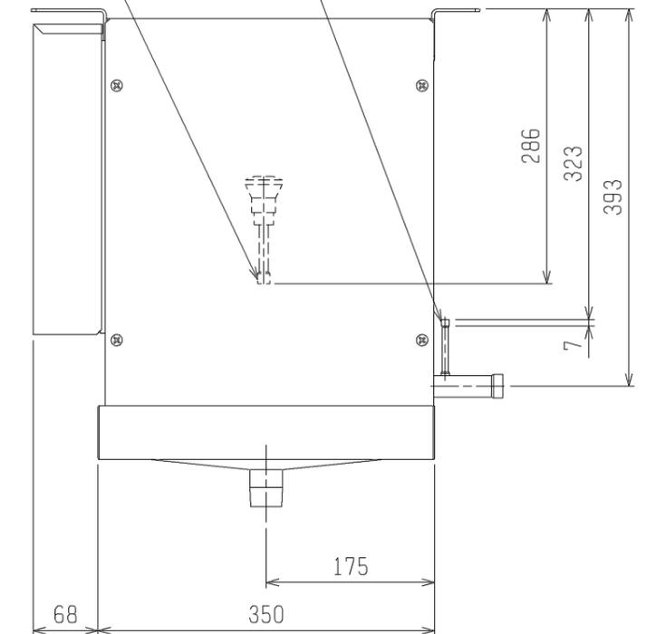
注1. 冷却器入口配管寸法は付属の膨張弁出口径に合わせております。
