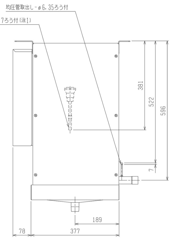
注1. 冷却器入口配管寸法は付属の膨張弁出口径に合わせております。
