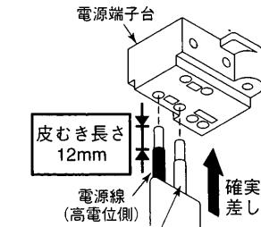
電源線接続の連結端子の電源線を取り外すときは、幅6mmのマイナスドライバーを、はずし穴にまっすぐに差し込んでください。
