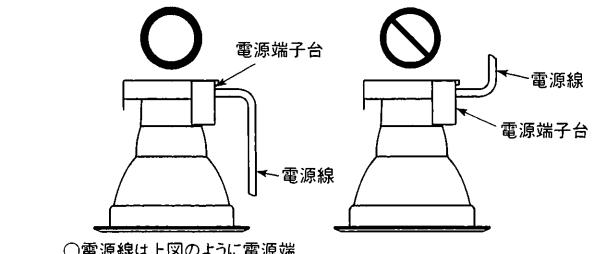
○電源線は上図のように電源端子台より天井面側へ向かって折り曲げてください。
