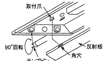
○反射板の角穴を本体天井面に設けられた取付爪に片側2ヶ所を引っ掛け、反射板をつまみながら、もう一方の角穴を取付爪にはめこむ。
