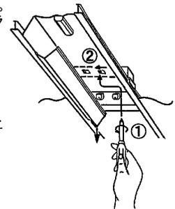
(3) Tバー取付金具のストッパがはずれたことを確認して、器具をとりはずす。
