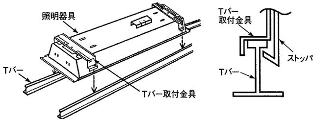
①Tバー取付金具のストッパが正しい位置にあるか確認する。位置がずれているとTバーにストッパが引掛かりません。
