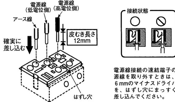
電源線接続の速結端子の電源線を取り外すときは、幅6mmのマイナスドライバーを、はずし穴にまっすぐに差し込んでください。
