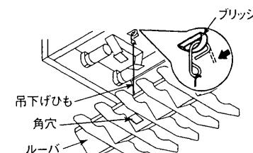
(2) ランプビンをソケットに差し込み、90°回転させ、ランプを確実に装着する。
