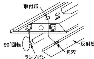
○反射板の角穴を本体天井面に設けられた取付爪に片側2ヶ所を引っ掛け、反射板をつまみながら、もう一方の角穴を取付爪にはめこむ。
