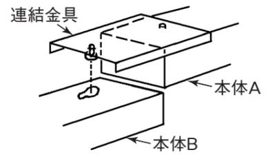
⚠️ 警告 器具の取付けは質量に耐える所に取付ける (落下の原因)
