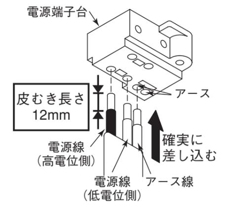
○電源線接続の速結端子の電源線を取り外すときは、幅6mmのマイナスドライバーを、はずし穴にまっすぐに差し込んでください。
