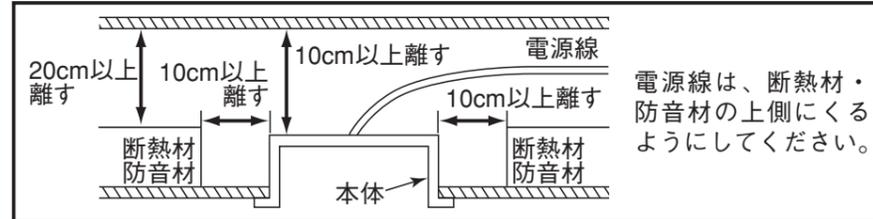
電源線は、断熱材・防音材の上側にくるようにしてください。
