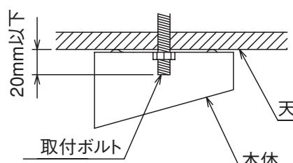
○器具質量に十分耐えるようボルト取付部の強度を確保する。
