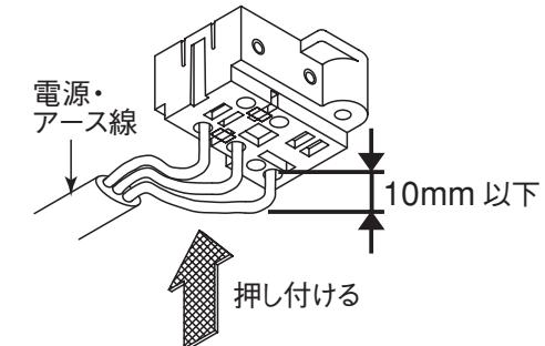
※器具内で送り配線を行う場合は、反射板との当たりを防ぐため、電源線にたるみないように配線する。
