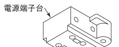
\*電源線の送り配線は必ず中央電源穴を使用する。
