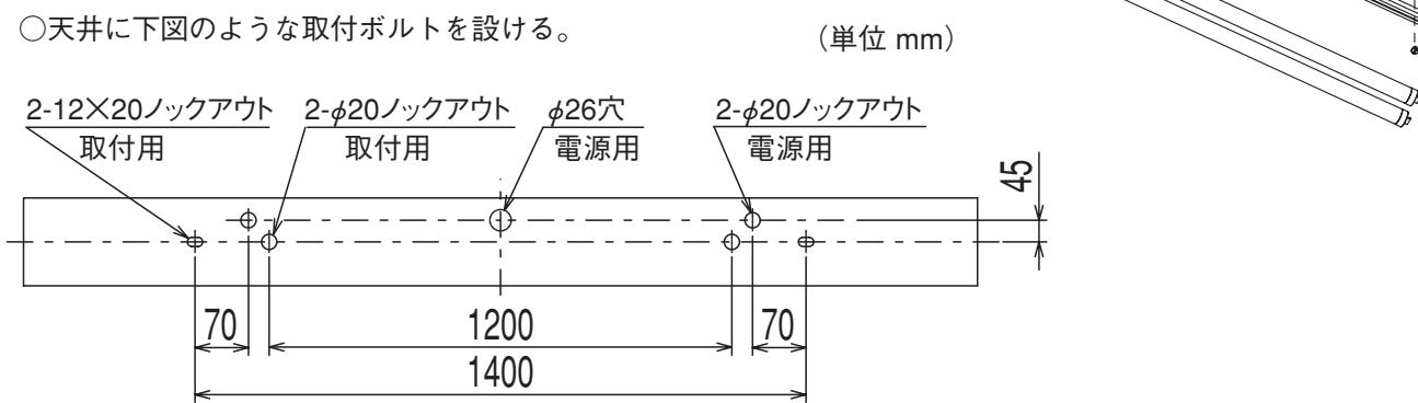
○取付ボルト長さは、天井面より20mm以下にする。
