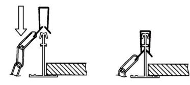
(2) ①ルーバ枠の一方の長片をTバーの上にのせかけながら押し込む。 ②枠保持ばねをTバーの開口側に押し込んで仮止め状態にする。
