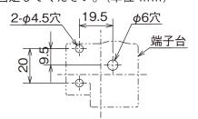
②端子台取付金具用の穴をあける場合 下図の取付穴を既設器具本体に加工して ください。(単位 mm)
