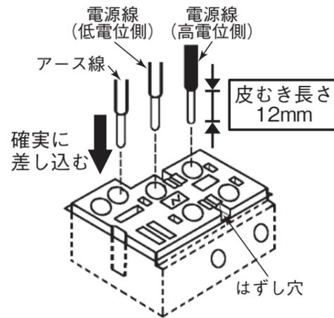
電源線接続の速結端子の電源線を取り外すときは、幅6mmのマイナスドライバーを、はずし穴にまっすぐに差し込んでください。
