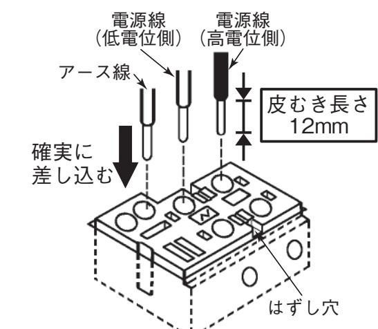
電源線接続の速結端子の電源線を取り外すときは、幅6mmのマイナスドライバーを、はずし穴にまっすぐに差し込んでください。
