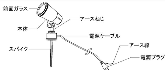
■器具の取り付けかた ※器具取り付けの際は必ず電源を切ってください。
