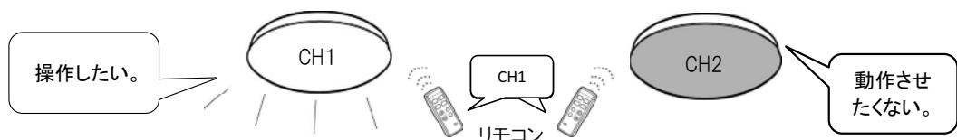
※照明器具が2台設置されていて、それぞれの本体チャンネルを「1」と「2」にする場合、1台の照明器具の壁スイッチはOFFしてから、手順1～3を操作してください。
