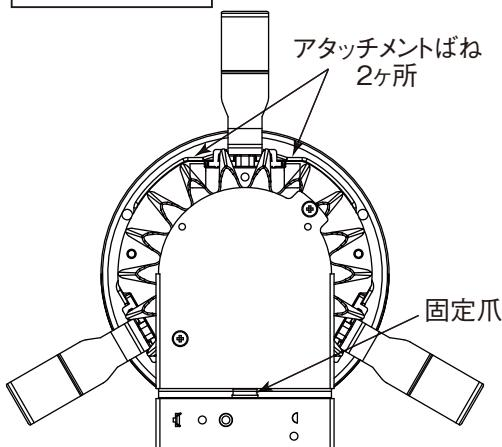
(1) ライトユニットのアタッチメントばねを反射板枠の角穴(小)に2ヶ所引掛ける。
