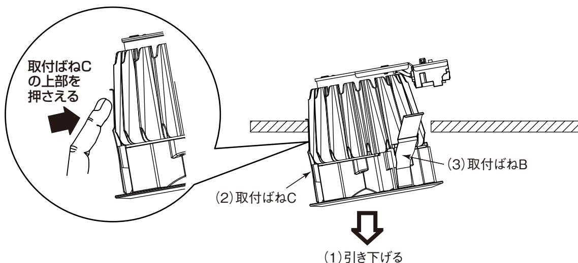
(3) 取付ばね A、B の引掛けりを外し、器具を取り外す。
