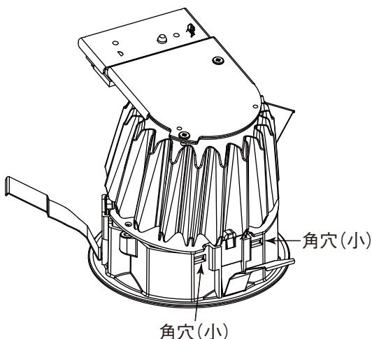
(2) ライトユニットの固定爪を反射板枠の角穴(大)に1ヶ所カチッと音がするまで押し込む。
