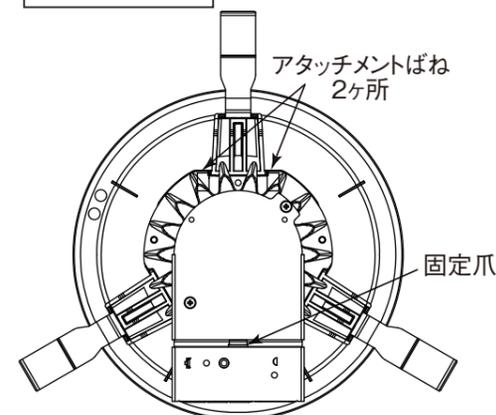
(1) ライトユニットのアタッチメントばねを反射板枠の角穴(小)に2ヶ所引掛ける。
