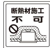
断熱材・防音材を使用する場合は、次の取付条件を守る。
