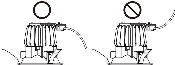
電源線に張力がかからないように上図のように電源端子台より反射板枠側へ向かって折り曲げる。
