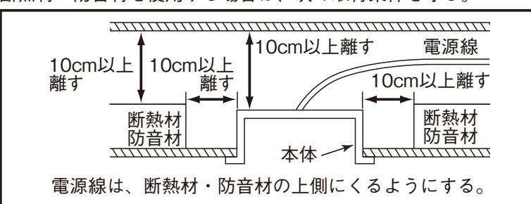
電源線は、断熱材・防音材の上側にくるようにする。
