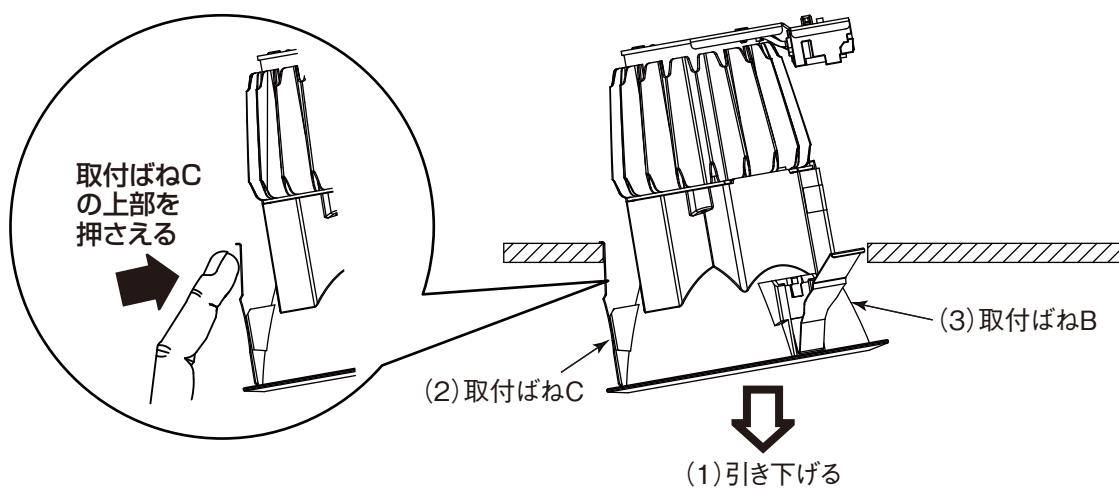
(3) 取付ばね A、B の引掛けりを外し、器具を取り外す。
