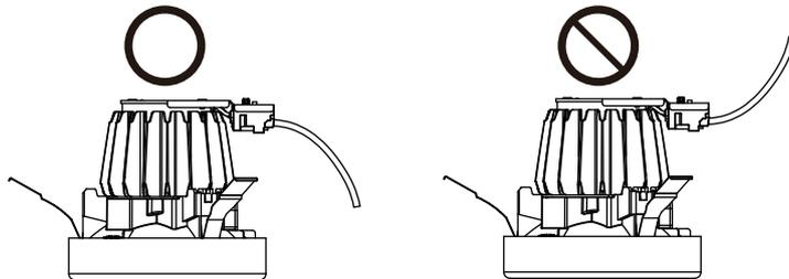
電源線に張力がかからないように上図のように電源端子台より反射板枠側へ向かって折り曲げる。
