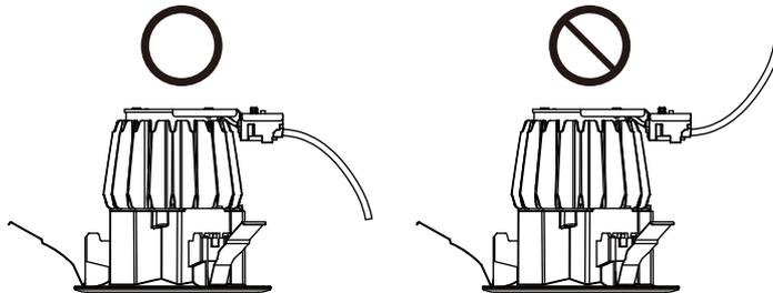
電源線に張力がかからないように上図のように電源端子台より反射板枠側へ向かって折り曲げる。
