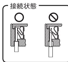
・電源線を電源端子台から取り外すときは、幅6mmのマイナスドライバー等で、解除ボタンを押しながら電源線を引き抜く。
