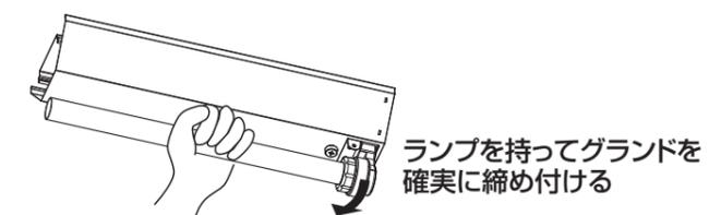
グランドとソケットに隙間が出ないようにしっかりと締め付ける。(隙間のある取付け、斜め締め付けをしない)
