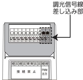
■ 各接続電線は動力線、高圧線との近接や束線を行わないでください。
